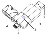
帽盖打开方式：轻轻旋转方可拔出帽盖
